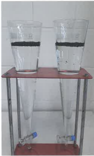
Bild 1. Bestimmung absetzbare Stoffe, keine Sedimentation des Reifenabriebs
