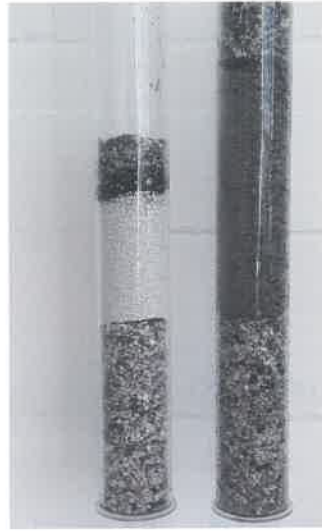
Bild 2. Versuchsaufbau in Anlehnung an ÖNORM B 2506-3 mit unterschiedlichen Substraten
