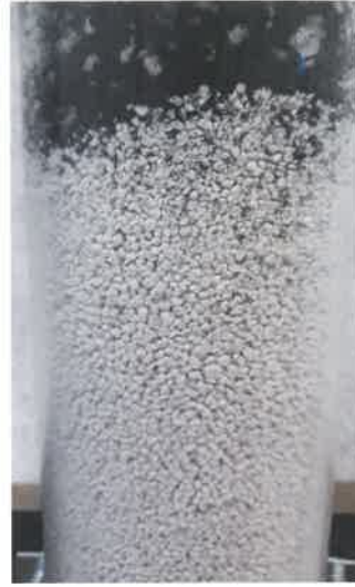
Bild 3. Filterkuchen oberhalb des Substrates
