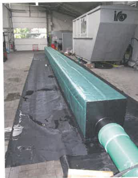
Bild 2. ENREGIS/Controlbox® Prüfstrecke in der iro-Forschungshalle (Abb.: iro Institut)
