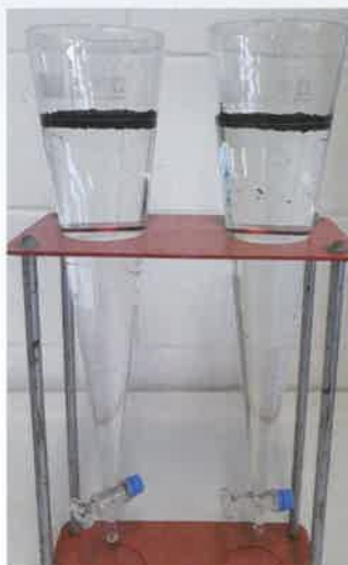
Bild 1: Bestimmung absetzbarer Stoffe, keine Sedimentation des Reifenabriebs
