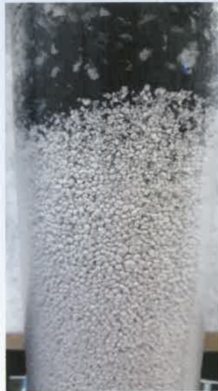
Bild 3: Filterkuchenbildung oberhalb des Biocalith/MR-F1 Substrats
