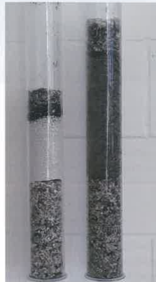
Bild 2: Versuchsaufbau in Anlehnung an ÖNORM B 2506-3 mit unterschiedlichen Substraten
